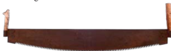
Tvåmans stocksåg med buktad sågtandsida och inte så kraftiga sågtänder som andra stocksågar. Längd 112 cm, bladbredd på mitten 15,5 cm. Kvarkens båtmuseum.
