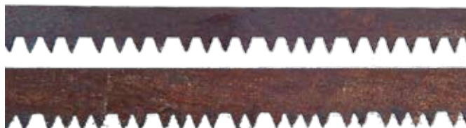
Bågsåg med stålåge har varit den vanligaste sågen för fällning och kapning innan motorsågen tog över. Spänningsanordningen för sågbladet kan skilja sig mellan olika sågfabrikat. Ovan de båda sågarnas blad. Kvarkens båtmuseum.
