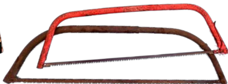
Röda bågsågen: längd nedtill 99 cm, sågdjup 23 cm, bladbredd 2,0 cm. Brun bågsågen: längd nedtill 116 cm, 24 cm, bladbredd 2,6 cm.
